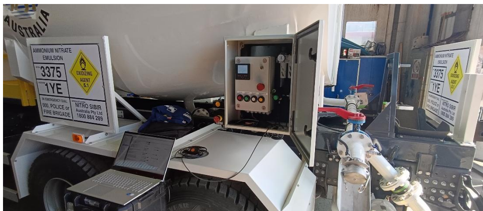
Slika 6: Validacija sistema na mobilni dozirni cisterni v realnem obratovalnem okolju
