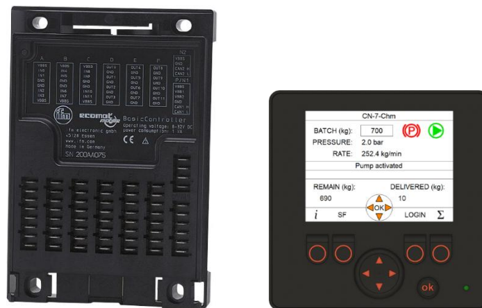
Slika 2: Krmilni sistem IFM CR0403 [5] in prikazovalnik IFM CR0451 [6]
